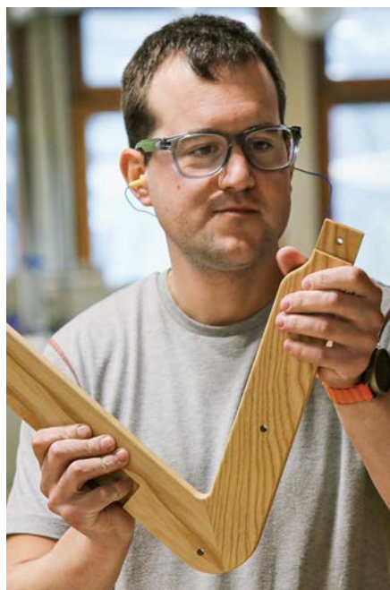
Nach der Arbeit mit der Handoberfräse prüft Schreiner Oliver Linder, ob das Holz wirklich überall gut verarbeitet ist und keine Gefahr durch Holzsplitter besteht.
