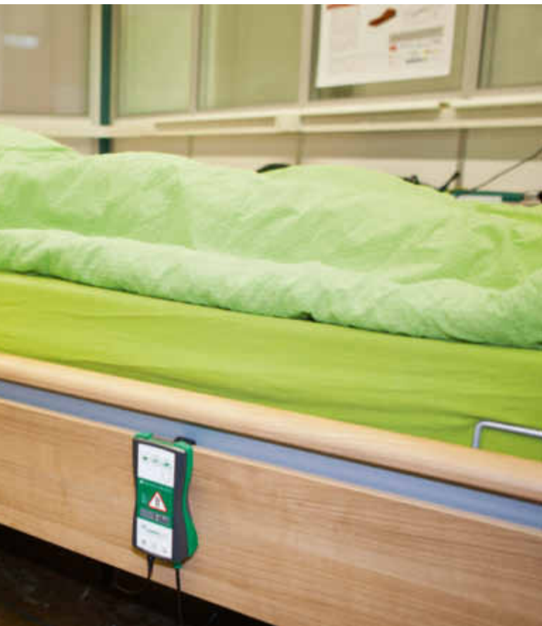
Bewegungsmelder am Bett: Das System erkennt, ob die bettlägerige Person ihre Druckstellen genügend entlastet.
